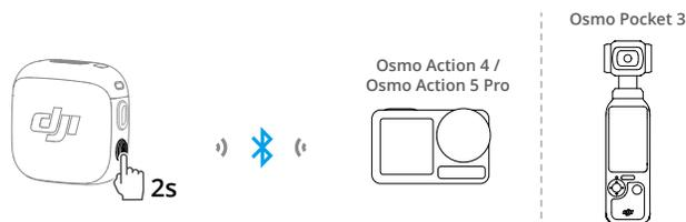
Aceda à interface de definições do sistema dos dispositivos de filmagem DJI. Toque em **Microfone Sem Fios** e adicione o transmissor. A ligação é bem-sucedida quando o LED de estado no transmissor apresenta uma luz azul continuamente acesa.
